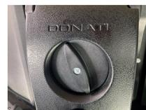
Réglage semi automatique de la tension.
