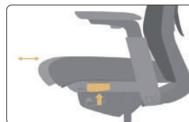
Réglage profondeur assise
