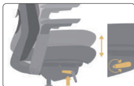
Réglage hauteur du siège
